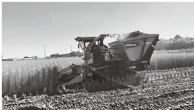
汎用型微細断飼料収穫機（SMW5200） 高糖分イネには乳酸菌「畜草2号」を添加します。
